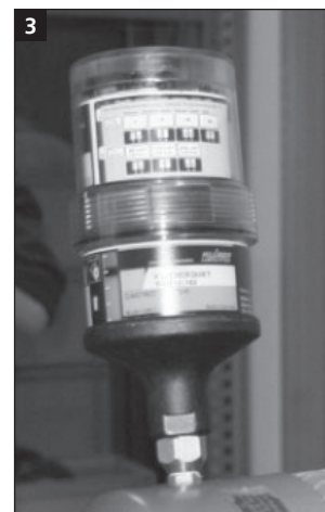
3 Die vormontierte Nachschmiereinheit (E, F, H) einschrauben
