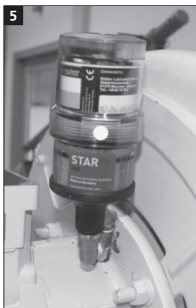
5 Die vormontierte Nachschmiereinheit (E, F, H) einschrauben
